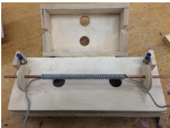
Ontvanger met ijzeren naald en spoel
