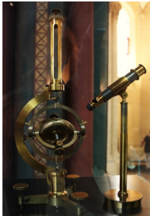
Figuur 3: de gyroscoop van Foucault. De bol verving hij door een metalen schijf, en hij mat de verandering van de hoek van de gyroscoop met behulp van een microscoop. [Wikimedia Commons]
